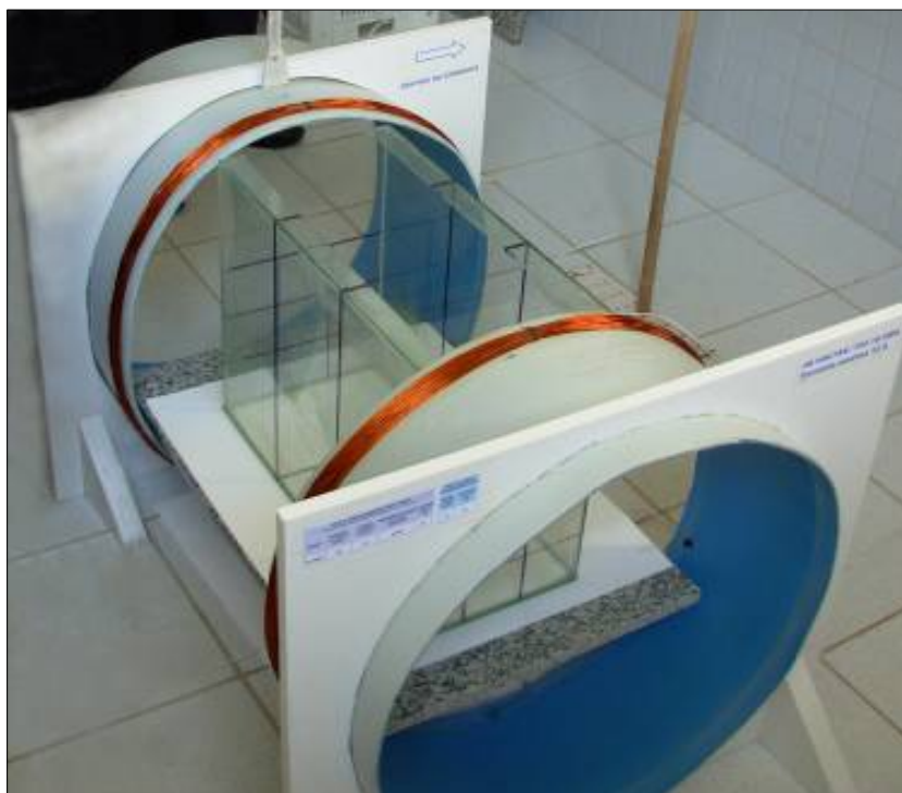
Figura 16. Arranjo geral das bobinas de Helmholtz utilizadas nos testes em laboratório.
