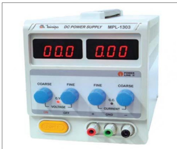
Figura 17. Fonte digital variável DC Minipa, MPL 1303 (30V/3A) de alimentação das bobinas.
