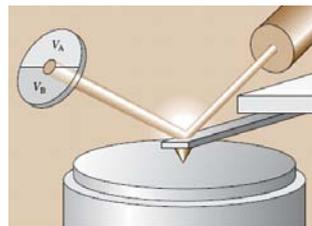
**Figura 4.2:** Ilustração do sistema de deflexão de feixe de laser comumente utilizado, que detecta o deslocamento do *cantilever* em um microscópio de força atômica [1].
