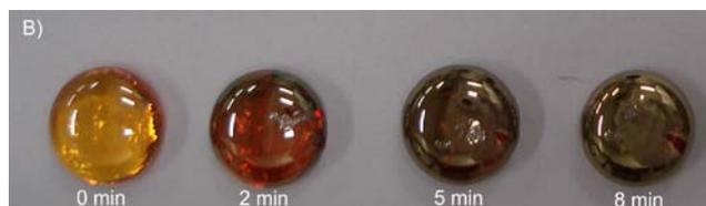
**Figura 5.40:** A) Imagem de AFM obtida sobre a superfície da amostra GAPAgO(2.5)-62 sem tratamento térmico. B) Fotografia das amostras tratadas termicamente por 0, 2, 5 e 8 minutos na  $T_g$ .
