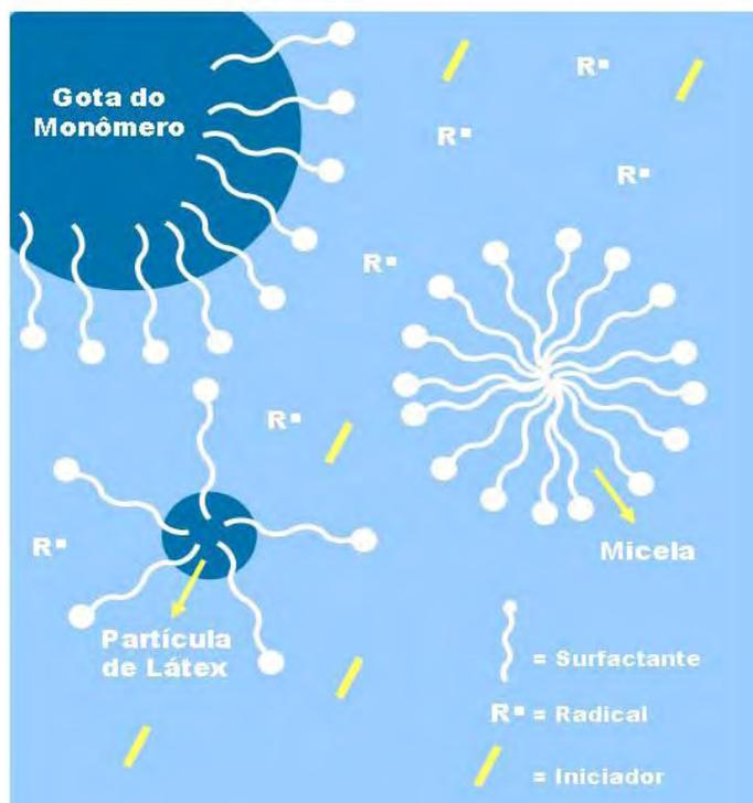
Figura 1. Uma representação esquemática do modelo de nucleação de micelas<sup>8</sup>.
