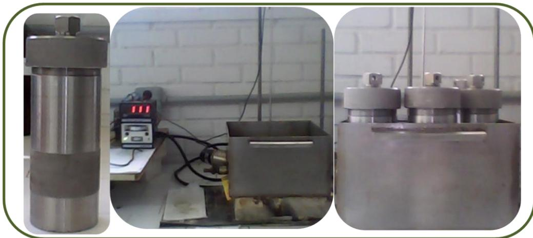
Figura 16. Da esquerda para direita estão: reator, banho e sistema de deslignificação.
