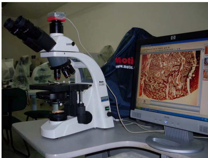
FIGURA 05 – Sistema de Captura de Imagens (microscópio MOTIC®, BA 300).
