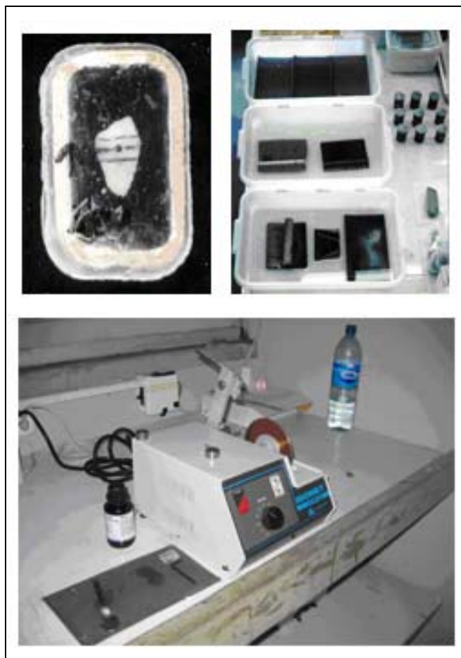
Figura 3.2: Otólitos inseridos em resina de poliéster (canto superior esquerdo), e processamento manual com lixas de diferentes granulações e polimento (canto superior direito), e abaixo o processamento das lâminas utilizando serra metalográfica.
