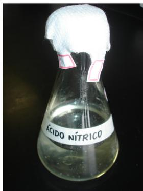
**Figura 5** – Solução de ácido nítrico a 10% para descalcificação dos fêmures.
