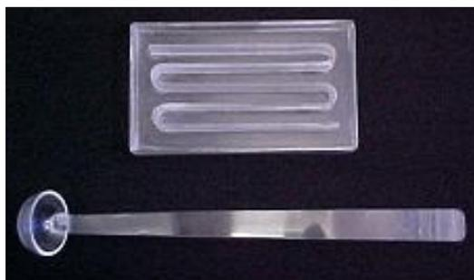
Figura 04. Placa de Bogorov e concha em acrílico (capacidade 10 mL) (Fonte: CAVALCANTI, 2002).
