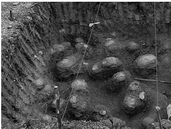
*Figura 7: Nível 1 (ou ovo de peixe) com concreções sub-esféricas ou ovóides que caracterizam esse nível.*
