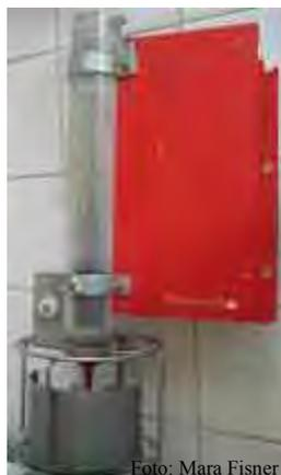
Fig. 13 – Correntômetro Sensordata SD 30
