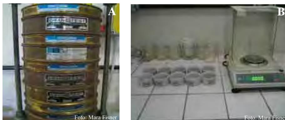
Fig. 17 – A) Agitador de peneiras; B) Balança de precisão
