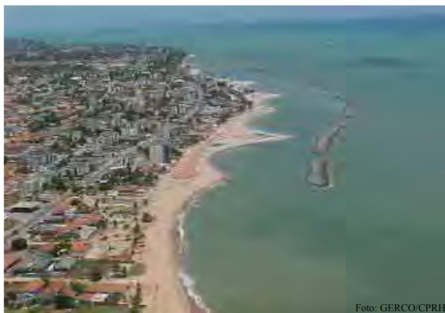
Fig. 5 - Vista aérea (S-N) dos quebra-mares semi-submersos construídos no Janga (2003)
