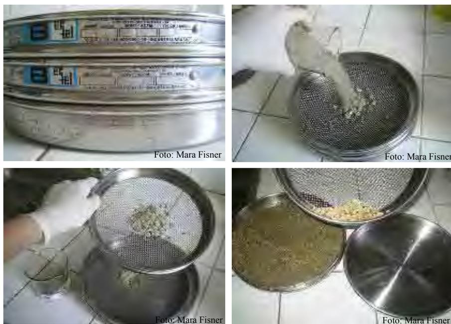
Fig. 16 – Peneiramento úmido.
