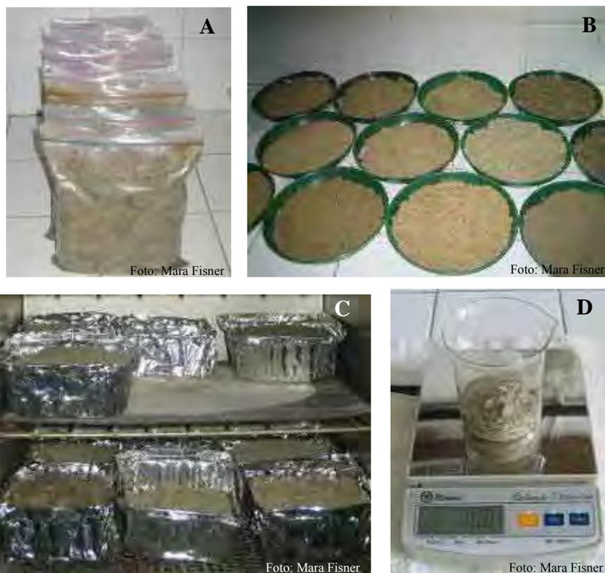
Fig. 15 – A) Amostras acondicionadas após a coleta; B) Secagem em temperatura ambiente; C) Secagem na estufa; D) Pesagem das amostras.
