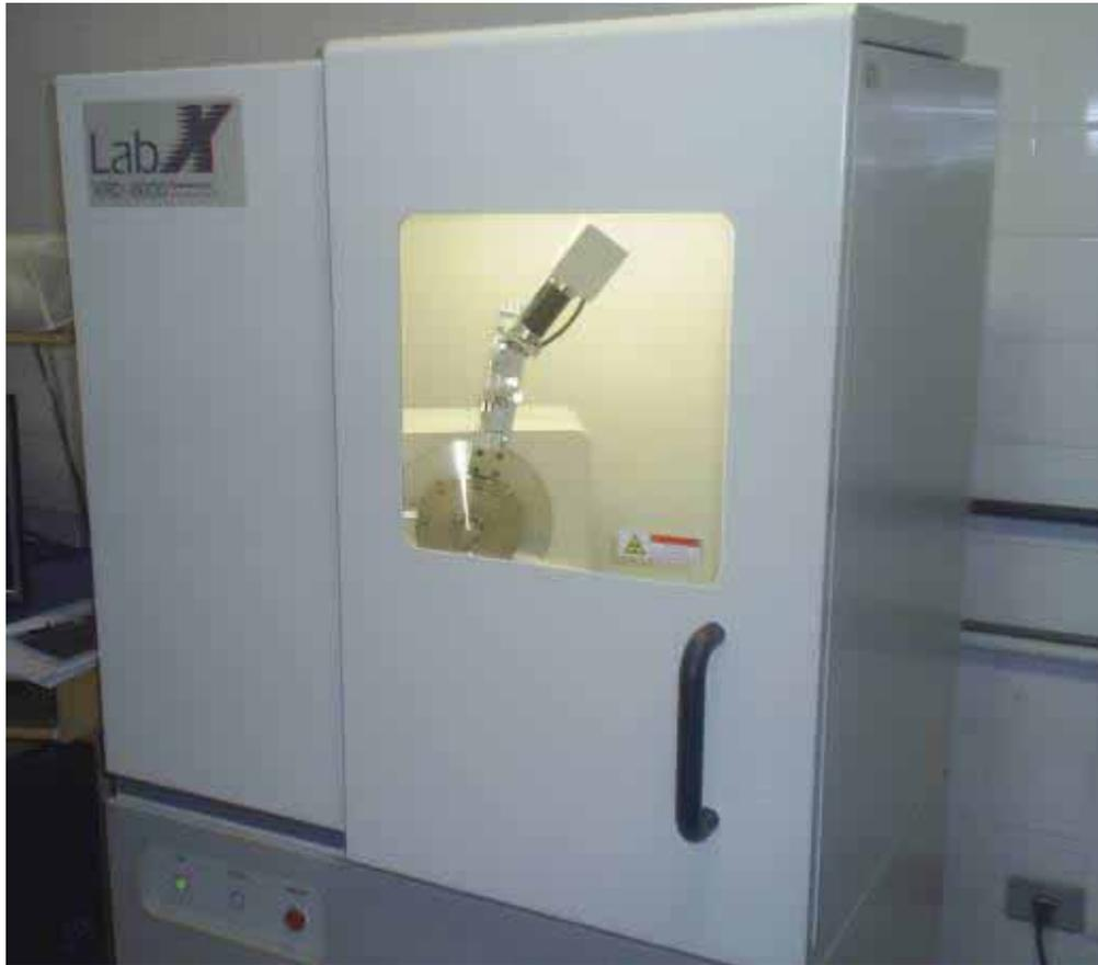
Foto 33 – Difratorômetro utilizado para as análises.
