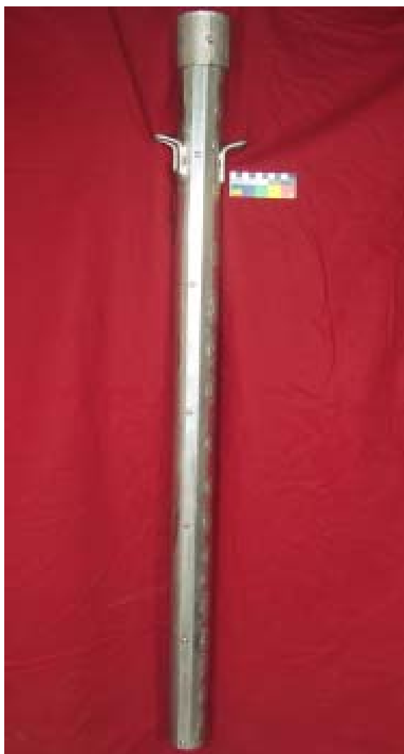
Foto12: Testemunhador de camada estratigráfica, adaptado pelo autor. Fonte: Carlos Rios.
