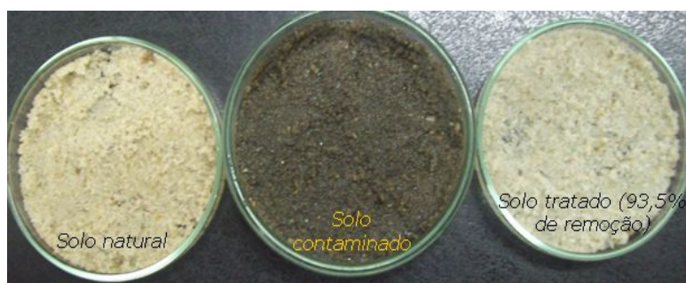
Figura 3. Aspecto do solo arenoso antes da contaminação, após contaminação por óleo automotivo e após biorremoção de 93,5% do óleo pelo biossurfactante produzido por C.lunata .
