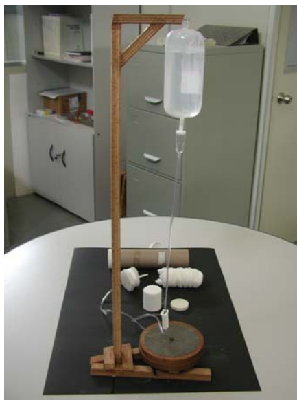
Figura (3.3.4)- Gotejador de água como medida para se manter a concentração inicial de água constante. Vazão de 1g de água por hora. Podemos ver ainda nesta foto o porta amostra de pvc, a referência, o algodão e a amostra de zeólita.
