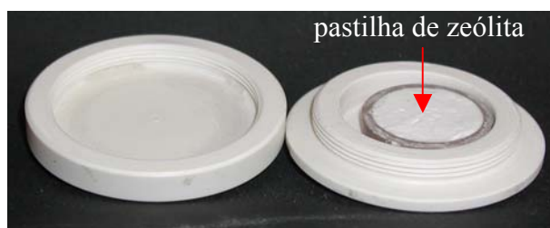
Figura (3.3.5)- Foto da referência utilizada no experimento. A seta vermelha indica a pastilha de zeólita que é selada dentro do compartimento de pvc.
