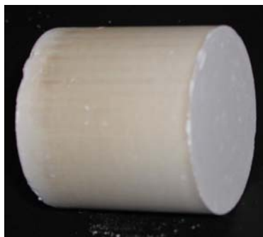
Figura (3.2.1)- Foto da amostra cilíndrica de zeólita com 5 cm de diâmetro e 5 cm de comprimento.
