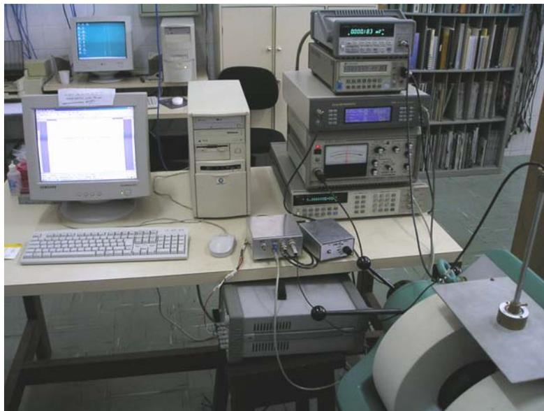
**Fig. 2.4:** Diagrama de blocos e foto digital da montagem de magnetoresistência DC. É possível observar outros equipamentos (tais como amplificador *lock-in*) que são utilizados na técnica de magnetoresistência diferencial (descrita na próxima seção).
