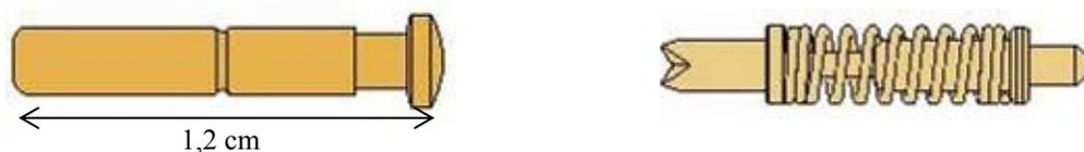
**Fig. 2.2:** Ilustração dos eletrodos utilizados para fazer os contatos sobre a superfície do filme, mostrando os detalhes da mola.
