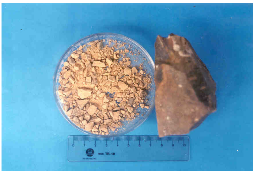
Figura 02: Amostra do basalto coletada na Região Metropolitana do Recife. Esquerda rocha inteira, direita material triturado para montagem dos experimentos.
