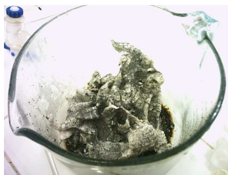
FIGURA 2.4: Após a combustão obtém-se uma frágil esponja que destrói-se ao ser tocada, o que fornece como resultado um pó finíssimo: o chamado produto da combustão
