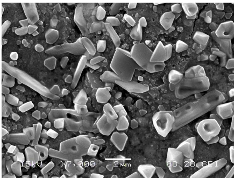
FIGURA 3.6: BLZO 2 - Micrografia obtida logo após a combustão
