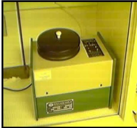
Figura 3.1. “*Spinner*” modelo P 6204 da **Specialty Coating Systems** usado para a deposição de filmes finos de polianilina.
