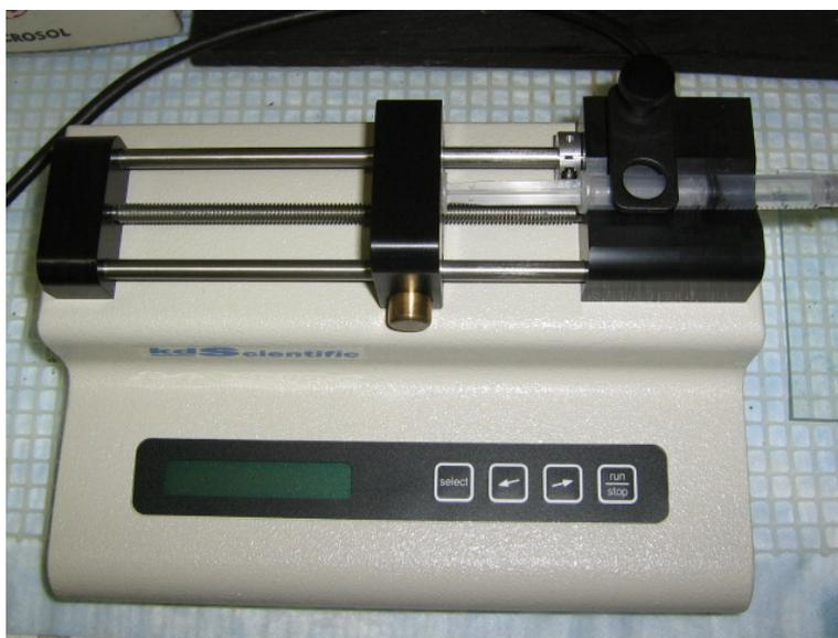
Figura 3.7. Bomba de seringa usada neste trabalho. Na parte inferior podem-se ver os controles do equipamento e o display onde aparece a informação, na parte superior é colocada a seringa, que é apertada pelo equipamento.
