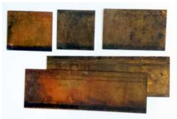
Figura 123 – Chapas de cobre que compõem os “fios” ou “filetes” tipográficos
