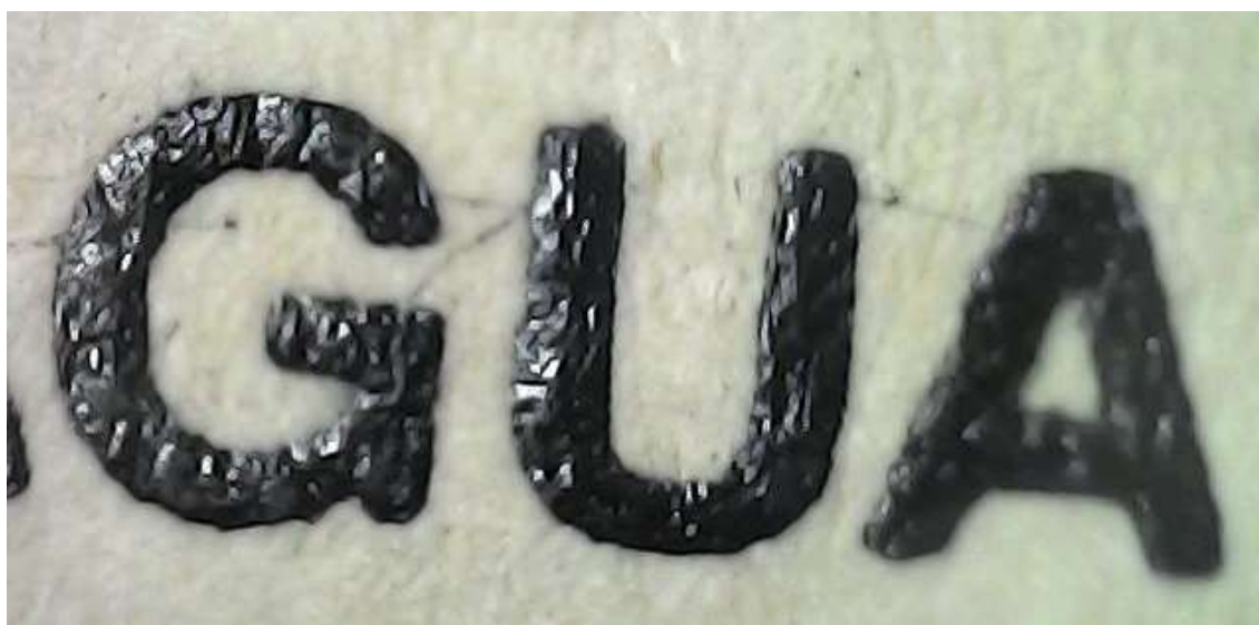
Figura 221 – Detalhe da impressão em relevo da edição fac-similar de Trilogia , visto por microscópio
