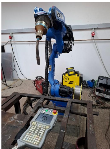
Figura 22 - Imagens da 1) Fonte Aristo 4004i Pulse, 2), pendant Aristo™ U82 e 3) YASKAWA-Motoman MA 1440
