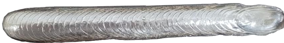
Figura 4 - Aspecto escamado da junta soldada por Superpulse
