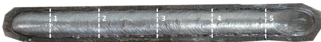
Figura 19 - Esquemático das regiões utilizadas na medição a geometria dos experimentos no DSD
