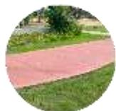
**Piso de concreto poroso (drenante):** Adotado para a pista de cooper, é um piso que facilita a prática de atividade físicas devido a sua estabilidade e no escoamento das águas pluviais.
