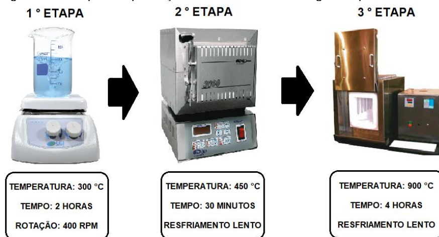
Figura 21 - Etapas de produção do tetraborato de magnésio por combustão.
