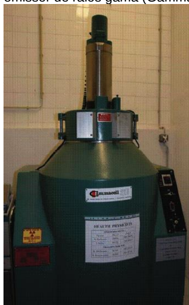
Figura 1 - Irradiador de \text{Co}^{60} emissor de raios gama (Gammacell 220 – Nordion, Canadá).
