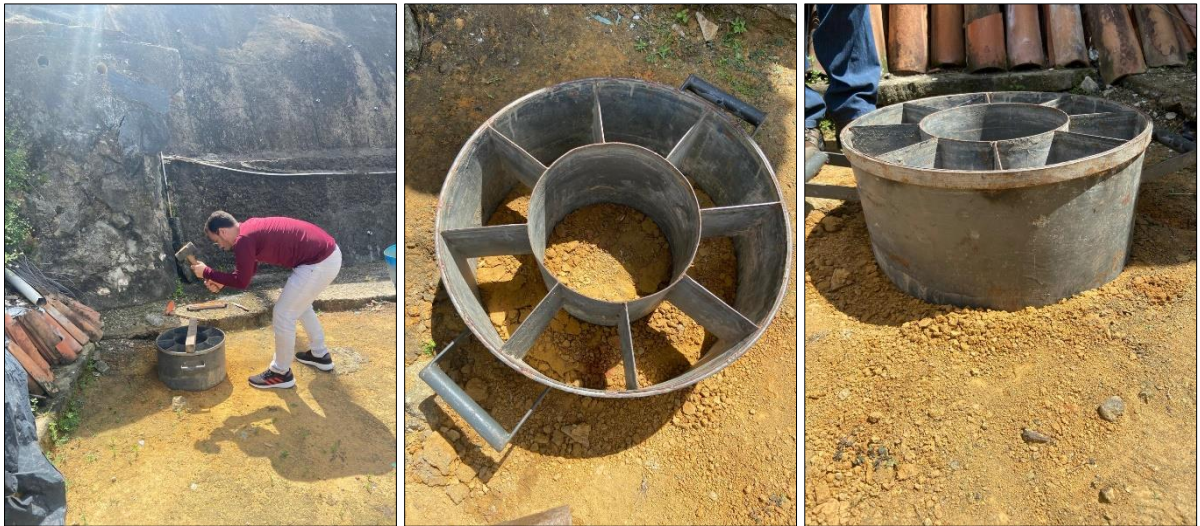
Figura 12 - Cravação do instrumento no solo.
