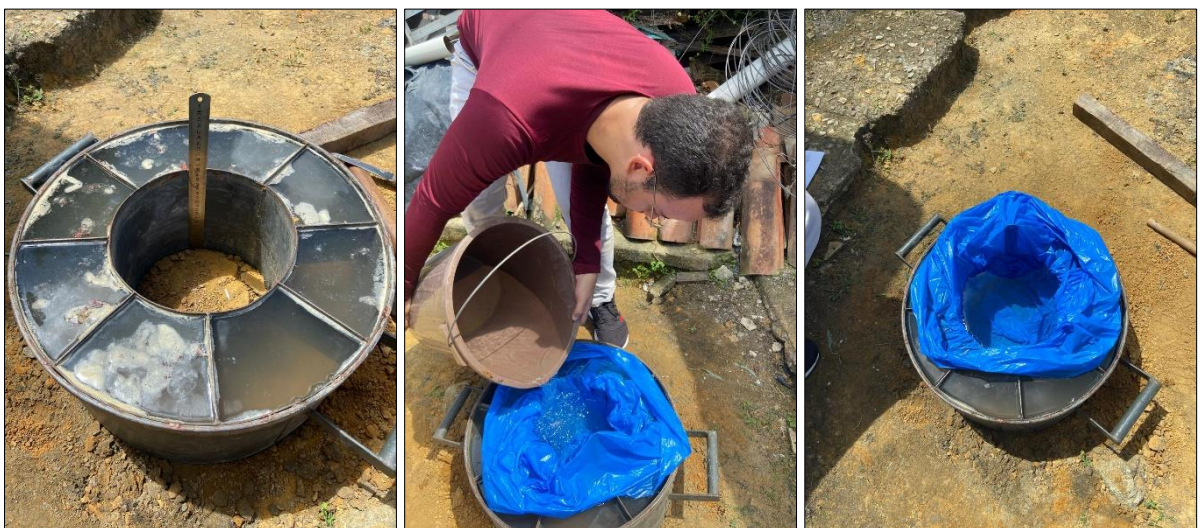
Figura 13 - Abastecimento de água para realização do ensaio.
