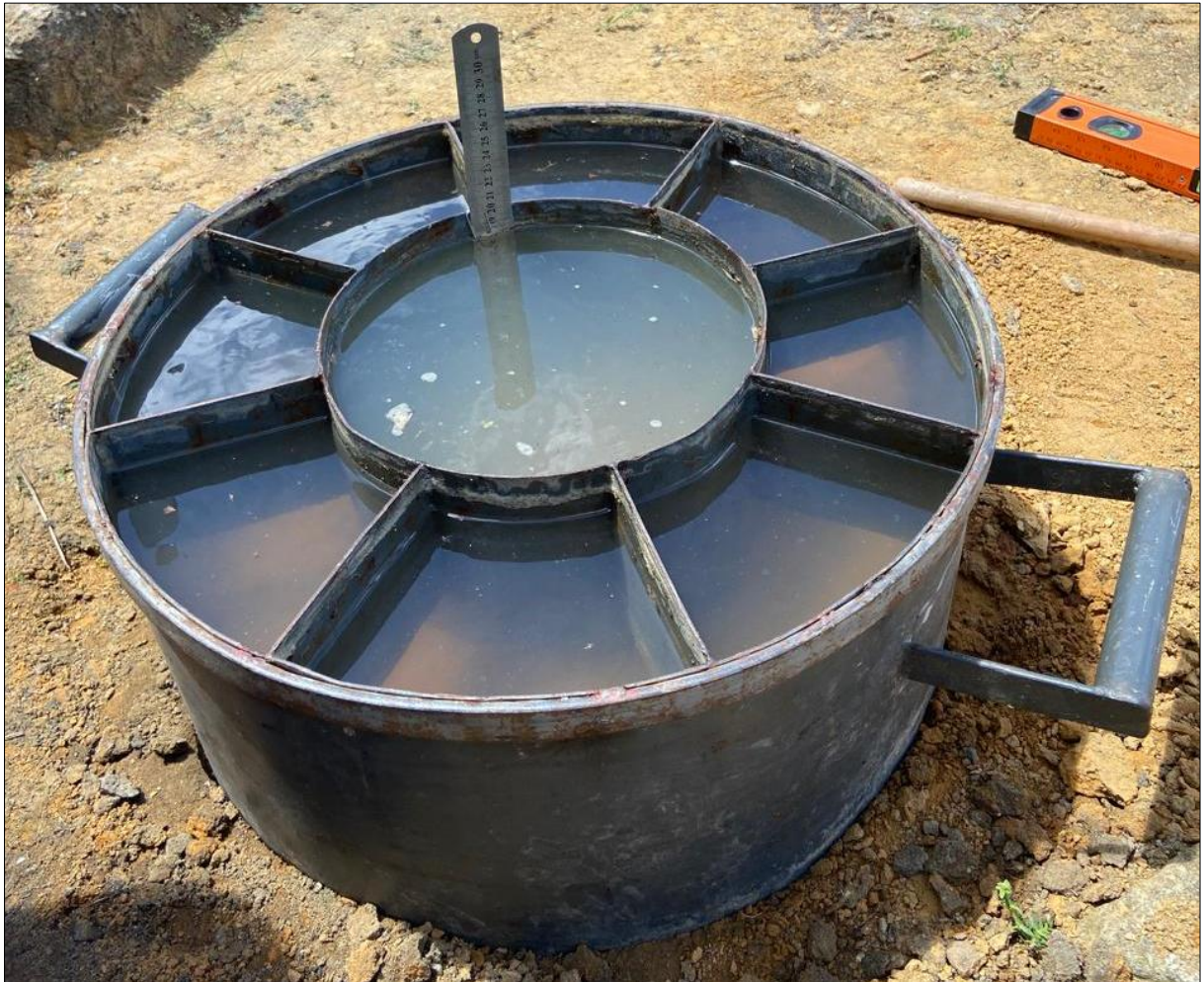
Figura 14 - Fase final do ensaio, realização de leituras.
