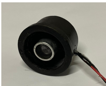
Figura 10 – Suporte com caps para posicionamento e estabilização do emissor e receptor.
