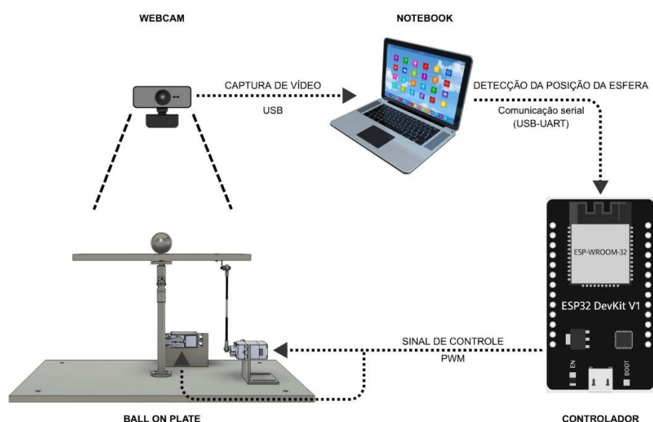
Figura 56 – Arquitetura do sistema de controle por visão computacional no Ball on Plate .
