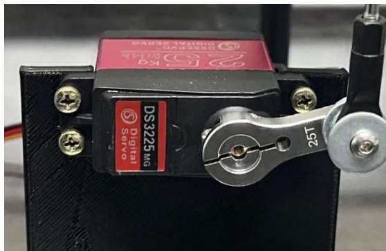
Figura 38 – Servomotor DS3225MG acoplado em sua estrutura de suporte.
