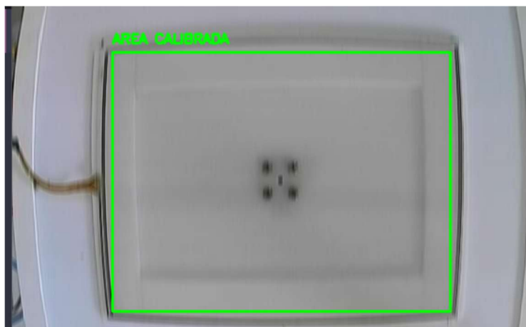
Figura 58 – Definição dos limites da região de controle para posicionamento da esfera no centro.
