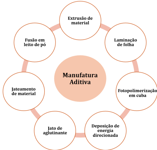
Figura 23. Sete categorias de processos da Manufatura Aditiva.
