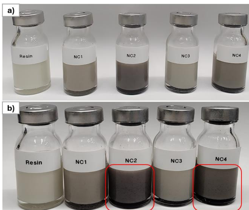
Figura 54. Homogeneização de nanocompósitos. a) Resina, NC1: (0,2% CuNP); NC2 (0,5% CuNP); NC3 (0,2% CuONP) e NC4 (0,5% CuONP) e b) mesmo material após 30 min.
