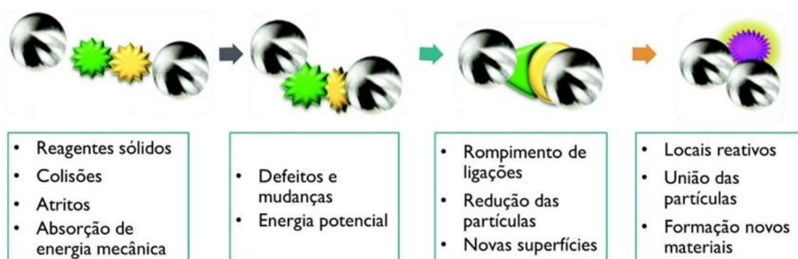
Figura 6. Diagrama da ocorrência de reações mecanoquímicas.
