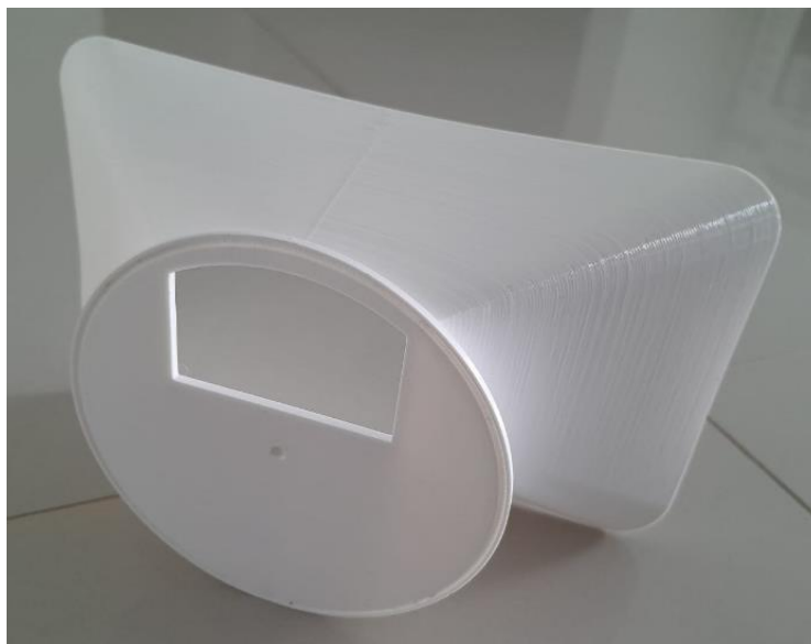
Figura 34 – Parte da tremonha que se conecta a roda dosadora.
