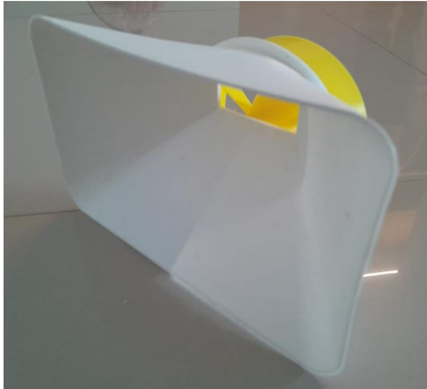
Figura 35 – Conexão entre a tremonha e a roda dosadora.
