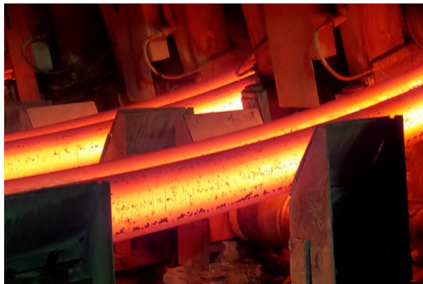
Figura 7. Lingotamento contínuo do aço.
