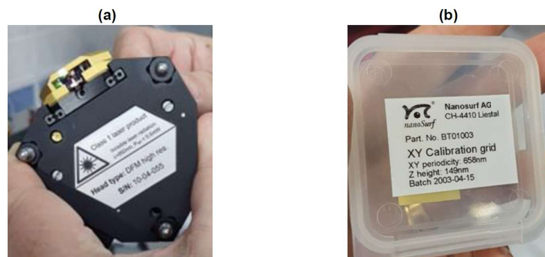
Figura 46: Fotos: (a) da parte inferior do microscópio AFM de alta resolução e (b) do padrão de calibração
