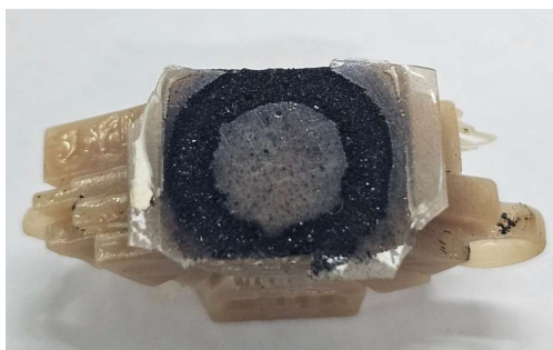
Figura 95: Imagens do efeito de campo na impressão (a) base da cidade Ameralabs e (b) bases de quatro discos, impressos com NC5
