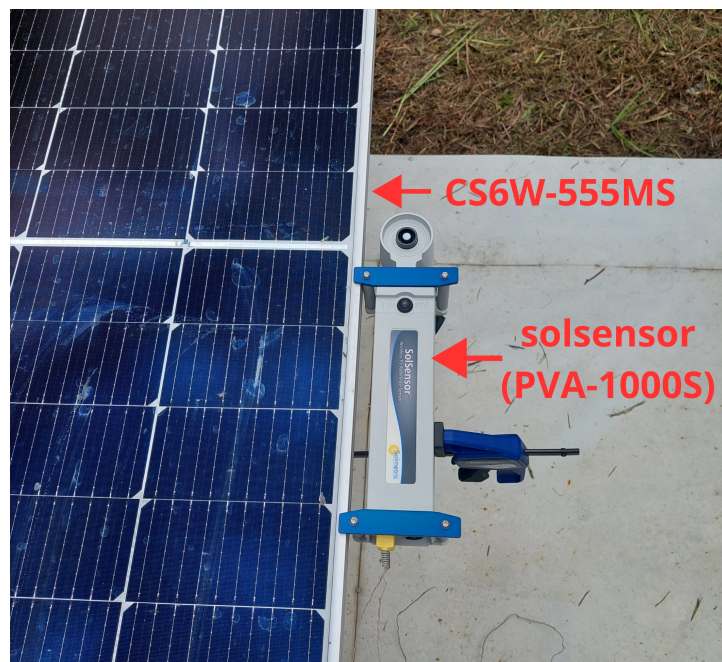
Figura 42 – Piranômetro (PVA-1000S) em operação com o módulo FV (CS6W-555MS).
