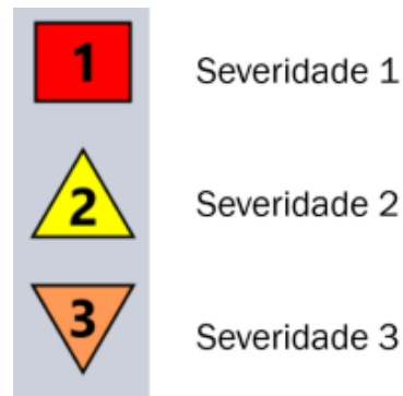
Figura 31 – Níveis de severidade de alarmes distintos por forma e cor.
