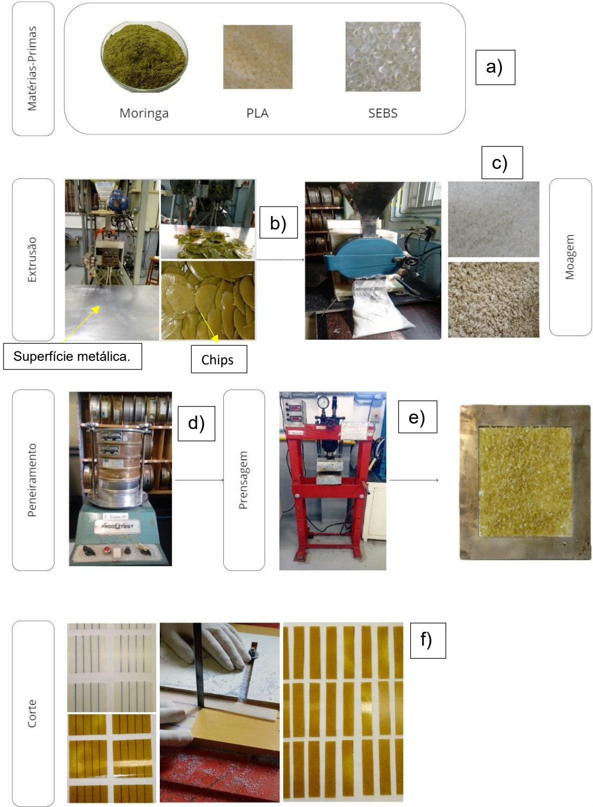
Figura 15 - Etapas para a produção das amostras a) matérias-primas, b) extrusão, c) moagem, d) peneiramento, e) prensagem/moldagem por compressão e f) corte/usinagem.
