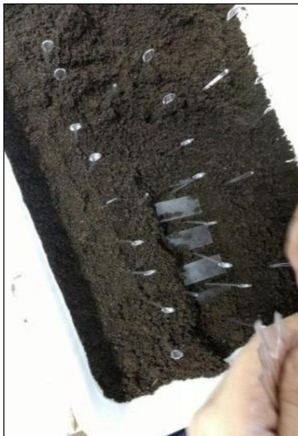
Figura 14 – Amostras no solo para ensaio de biodegradação com 0 dias de exposição.
