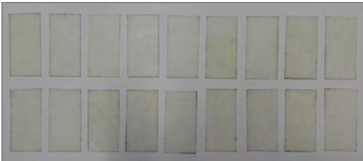
Figura 12 - Amostras de filmes do poli(ácido láctico) utilizadas no ensaio de biodegradação considerando a norma ASTM G-160-03.
