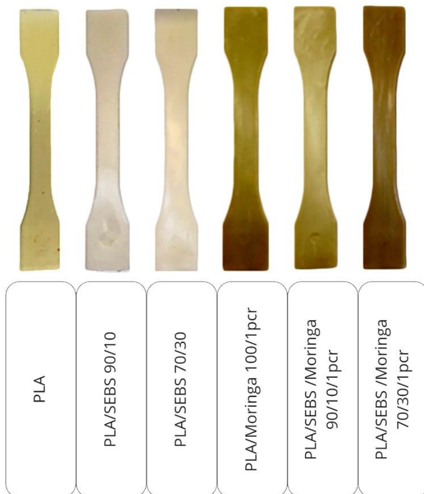
Figura 16 - Fotografia dos corpos de prova de tração injetados.
