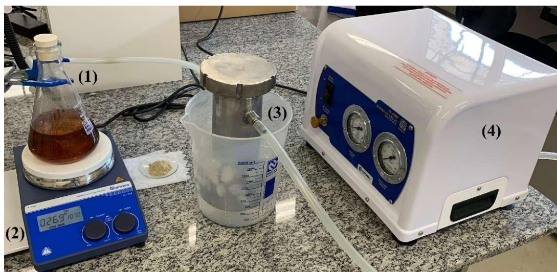
(1) Kitasato, (2) Chapa aquecedora com agitador magnético, (3) Estrutura adaptada para retenção de umidade, (4) Bomba a vácuo.
