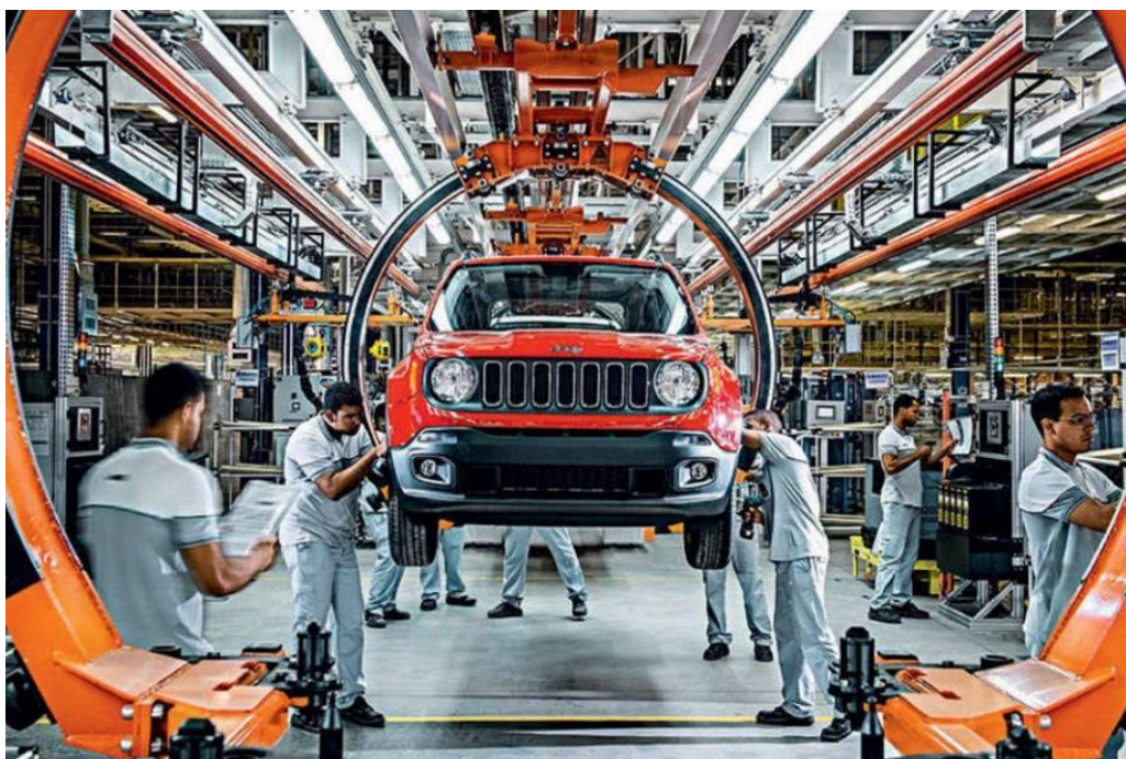
Figura 16 – Estação de operações manuais da linha de montagem da fábrica da Jeep Goiana (II)
