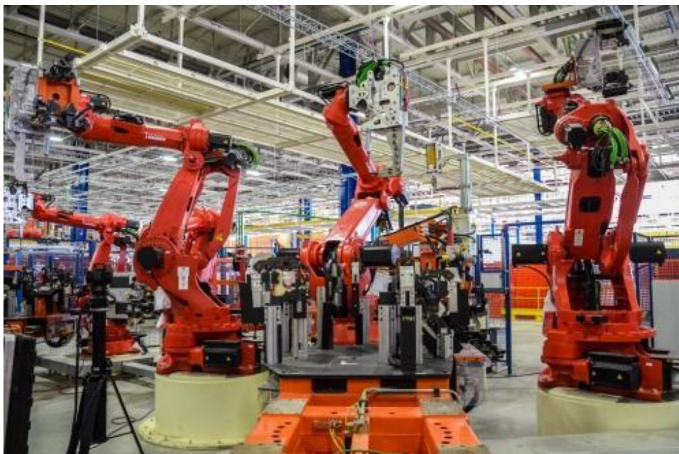
Figura 5 – Robôs da linha de produção autônoma do galpão de solda da Jeep Goiana (I)
