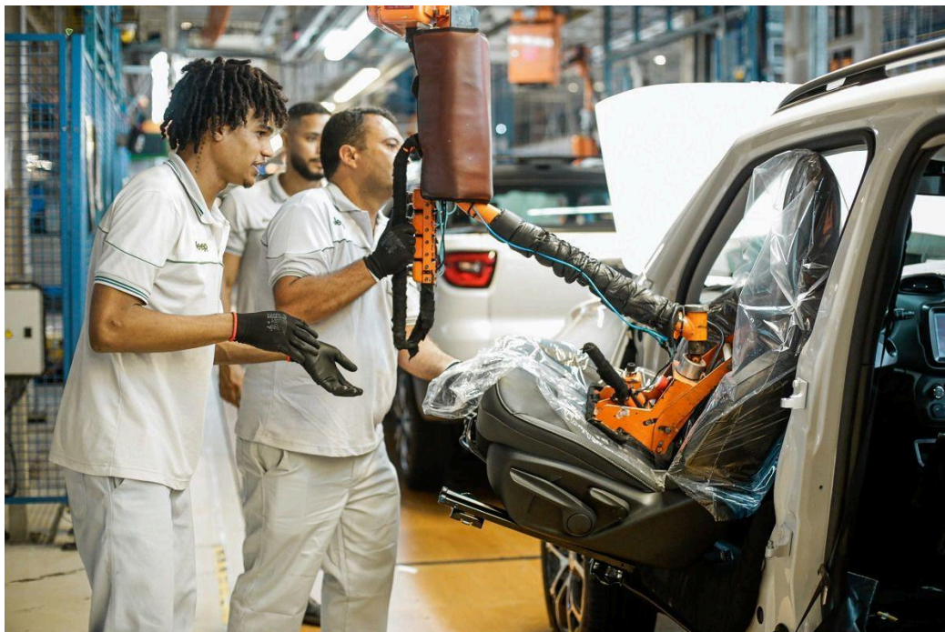
Figura 15 – Estação de operações manuais da linha de montagem da fábrica da Jeep Goiana (I)
