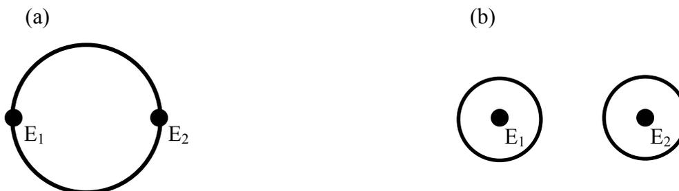
**Figura II.3.2** – Regiões de ganho (linhas pretas) geradas pelos efeitos de (a) “two-beam emission e (b) instabilidade modulacional, atuando isoladamente, quando dois feixes ópticos intensos,  $E_1$  e  $E_2$ , se interceptam em um meio não linear.
