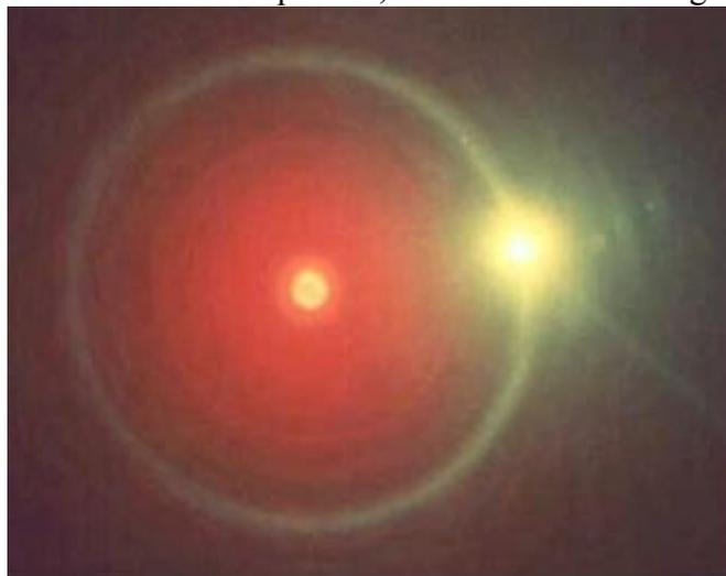
**Figura II.5.5** - Difração cônica observada em um anteparo posicionado a 30 cm da amostra. A potência do feixe em 583 nm é igual a 30 kW enquanto que a do feixe em 546 nm é < 2kW.
