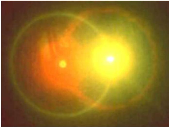
**Figura II.5.4** – Difração cônica observada em um anteparo posicionado a 30 cm da amostra. Os feixes incidentes possuem diferentes frequências e potências aproximadamente iguais a 30 kW.
