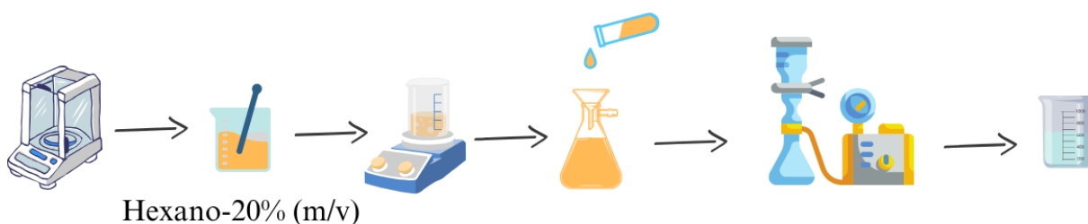
Figura 21. Esquema para purificação do monômero N-Vinilcaprolactama (NVCL)
