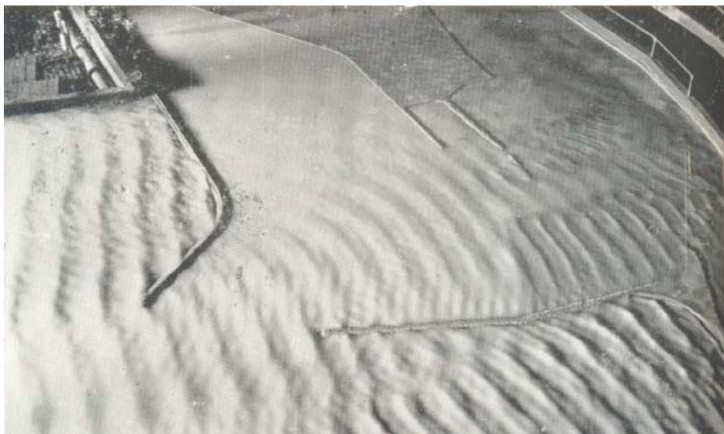
Foto 5.10 – Aspecto do modelo reduzido em funcionamento no laboratório Neyrpic, onde se percebe o aumento da turbulência e do empinamento das ondas ao Norte do molhe de Olinda. (Fonte: Guerreiro Júnior, 1958)
