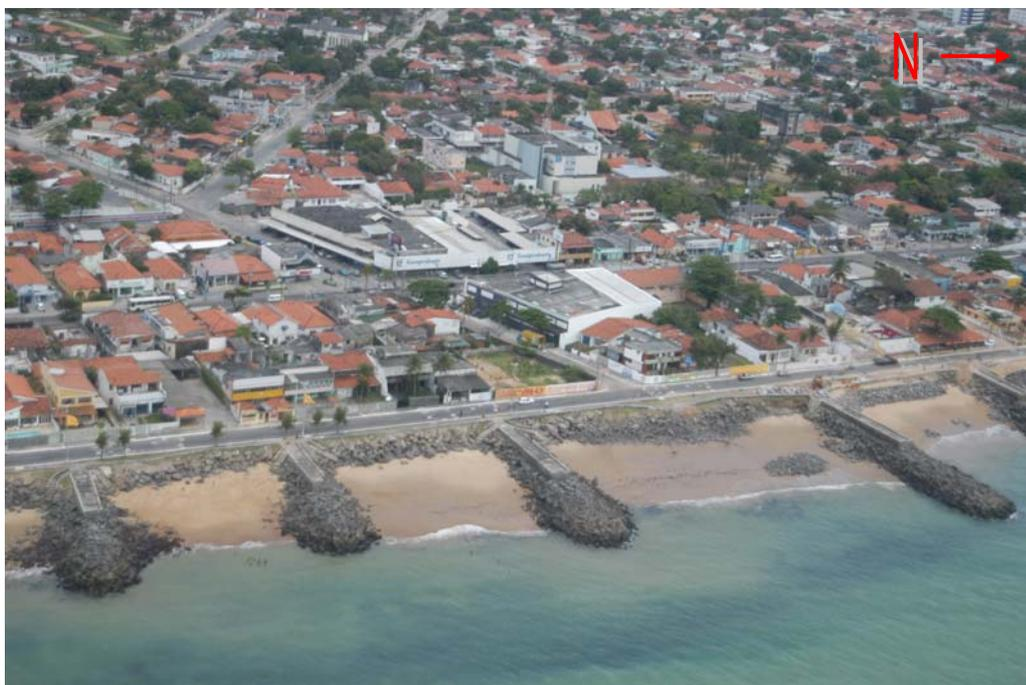
Foto 6.8 – Aspecto geral da Praia de Bairro Novo, mostrando alguns dos espigões construídos ao longo de sua orla. Notar as diferentes acumulações de sedimentos entre cada espigão. (Fonte: Diretoria de Meio Ambiente, Secretaria de Planejamento Meio Ambiente e Transportes de Olinda, 2004)
