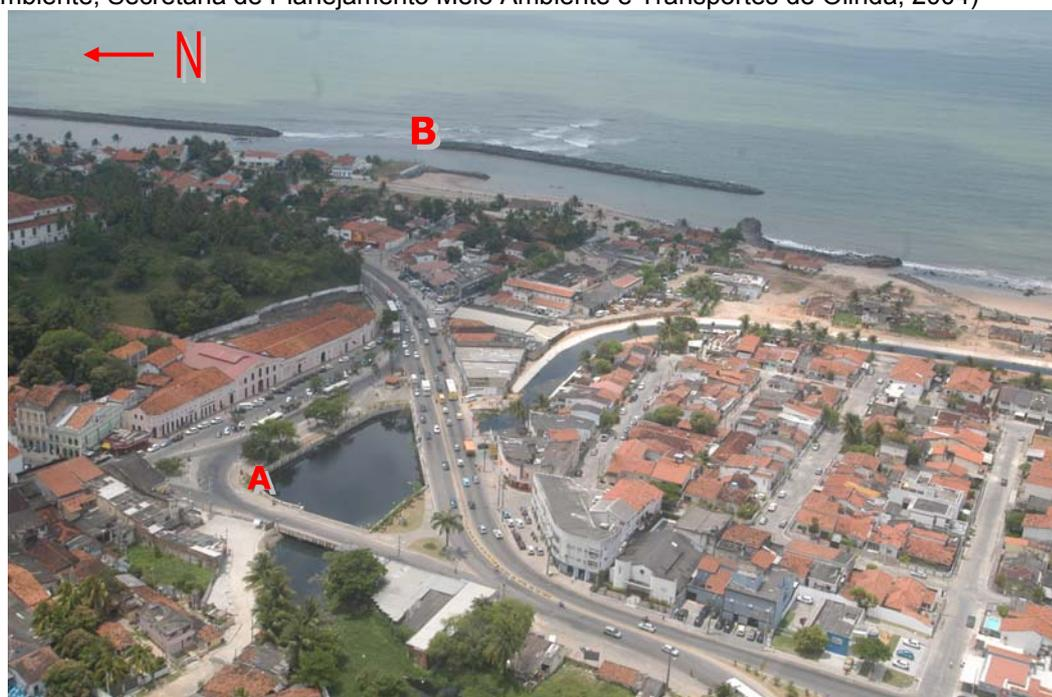
Foto 6.10 – Em primeiro plano, nota-se o Largo do Varadouro (A) e sua ligação com o Canal da Malária; ao fundo, vêm-se, ainda, obras de enrocamento aderente no início da Praia dos Milagres, bem como quebra-mares (B) construídos no início da década de 1960. Na maré baixa, é possível observar ruínas de casas destruídas pelo avanço do mar na década de 1950. (Fonte: Diretoria de Meio Ambiente, Secretaria de Planejamento Meio Ambiente e Transportes de Olinda, 2004)
