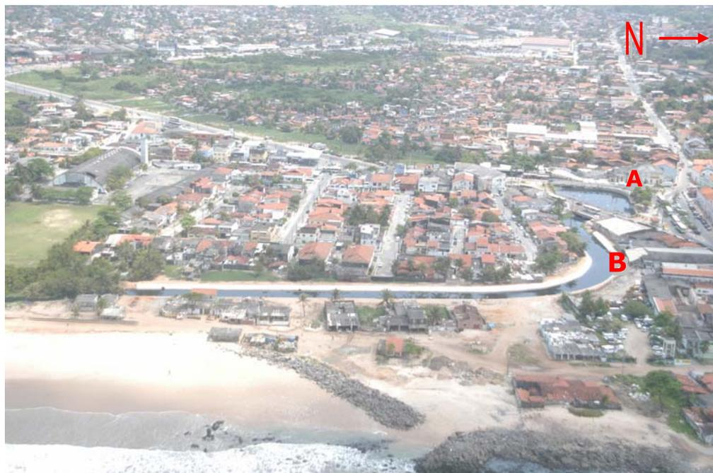
Foto 6.5 – Nota-se, em primeiro plano, obras de contenção construídas entre a Ilha do Maruim e a Praia dos Milagres, no canto direito da foto, vê-se ainda o Largo do Varadouro (A) e sua comunicação com o canal da Malária (B). A observação dos mapas anteriores a 1915 mostra que toda a área localizada ao sul do Canal da Malária era ocupada por mangues. (Fonte: Diretoria de Meio Ambiente, Secretaria de Planejamento Meio Ambiente e Transportes de Olinda, 2004)
