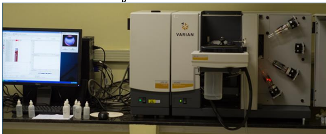
Figura 18 - Espectrômetro de Absorção Atômica VARIAN AA240Z (Zeeman) com forno de grafite GTA 120.
