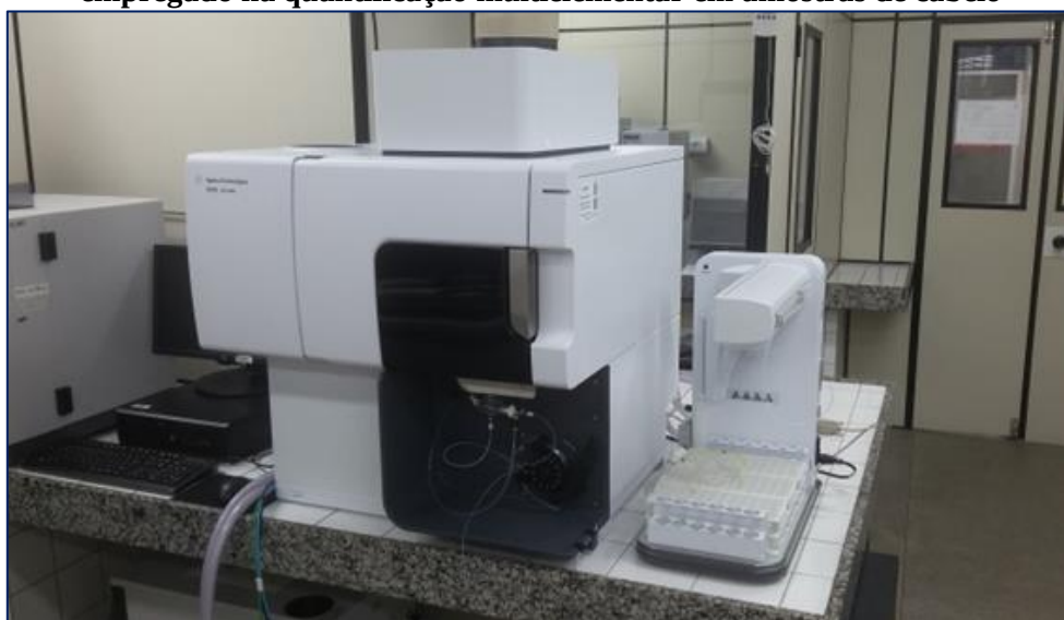
Figura 20 - Espectrômetro de Emissão Óptica com Plasma Acoplado Indutivamente empregado na quantificação multielementar em amostras de cabelo
