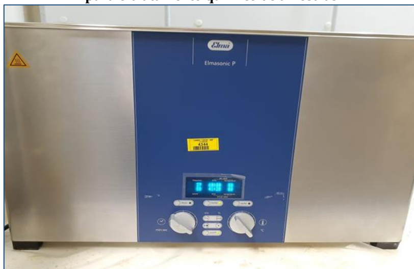
Figura 17- Equipamento de banho maria ultrassônico Elma Elmasonic P 180H empregado para o tratamento químico de amostras
