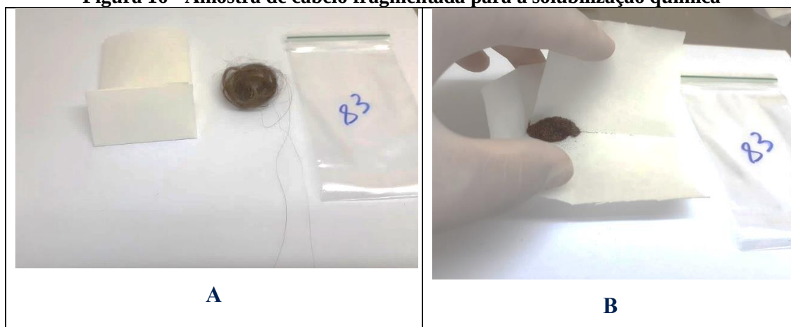
A= amostras de cabelo depois de seca em estufa até atingir peso constante; B= Amostras de cabelo depois de fragmentada para análise em EDXRF e abertura de amostras.
