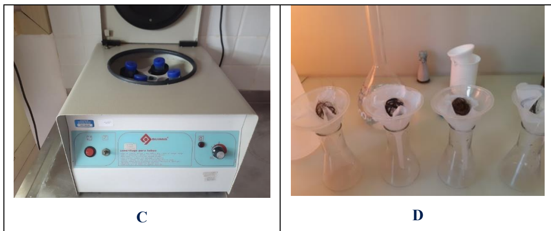
A= amostras de cabelo e tubos Falcon com cetona; B= Amostras dentro da cetona para centrifugação; C= Amostra sendo centrifugada; D= removendo cetona das amostras de cabelo para posterior secagem. Fonte: O autor (2024).
