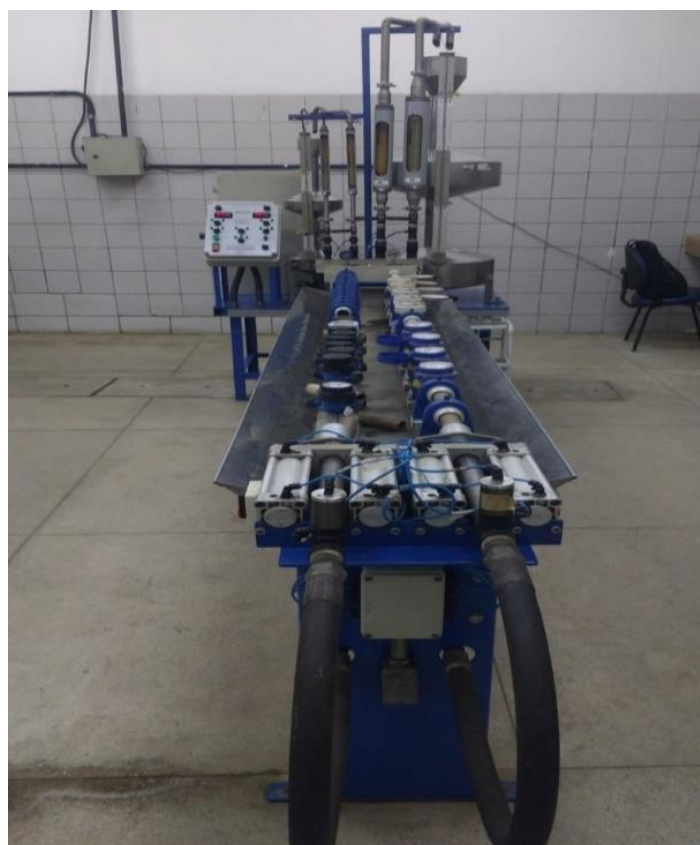
Figura 10. Bancada de calibração de hidrômetros da COMPESA.
