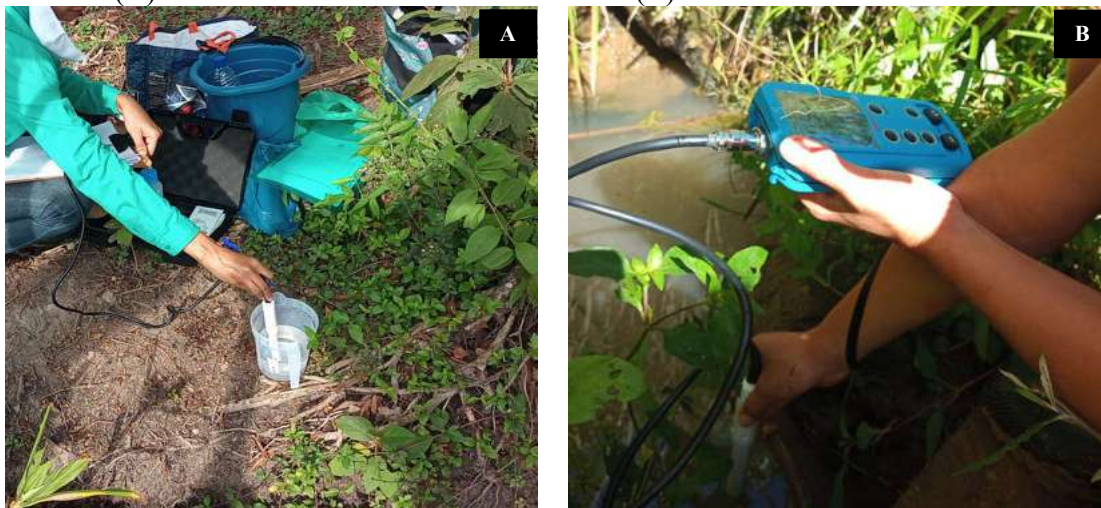
Figura 9- Medição dos parâmetros com medidor multiparâmetros, em nascentes de Correntes (A) e em nascentes de Santana do Mundaú (B).
