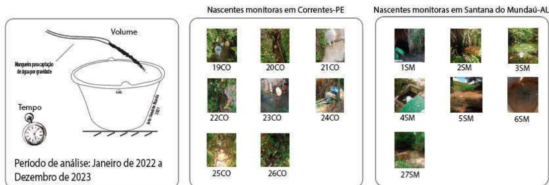
Figura 8- Método volumétrico direto para monitoramento hidrológico e nascentes avaliadas.
