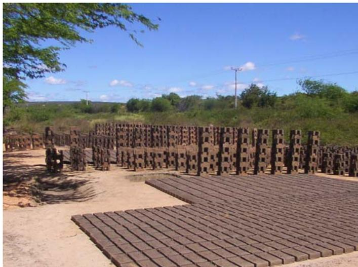
**Figura 10** – Tijolos produzidos no município de Ibimirim com a utilização de solos de aluvião. Presença de crateras provocada pela retirada do mineral.
