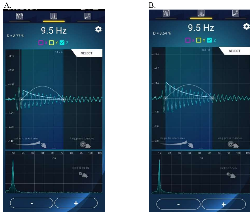
Figura 8 – Frequências naturais e razão de amortecimento
