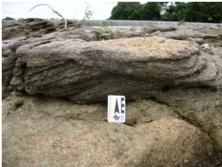
Foto 2.5 – Arenito Açú médio a grosso de matriz predominantemente argilosa com estratificação cruzada de pequeno porte. (ANA-11; 611032, 9437982).
