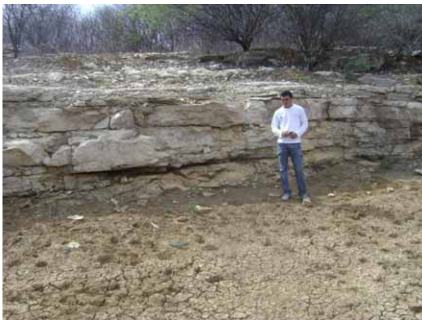
Foto 3.2 – Juntas de alívio de pressão dispostas horizontalmente e paralela ao acamamento (315 Az/horizontal) no calcário Jandaíra, Pedreira Bonsucesso – Jaguaruana/CE (ANA-108; 638136, 9441433).
