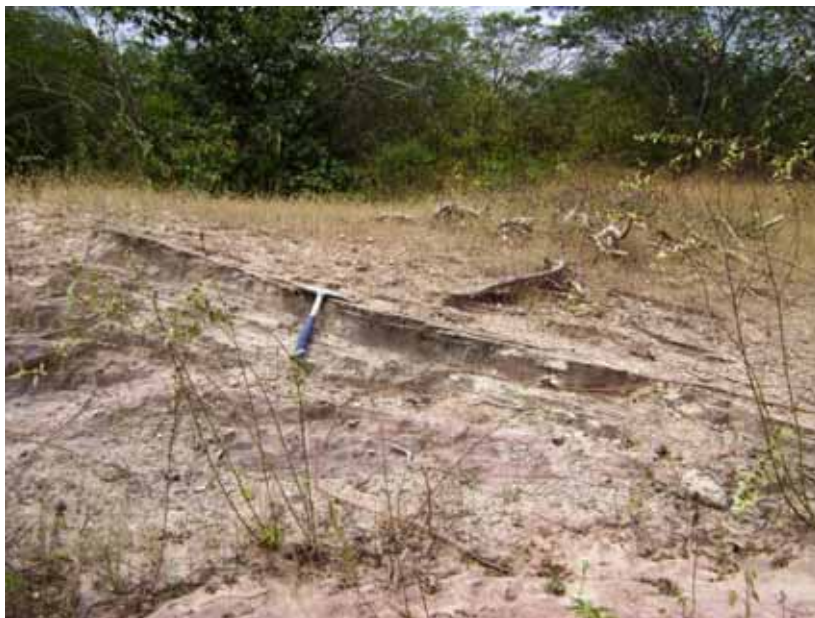
Foto 3.4 – Arenito Açú, plano de acamamento com direção 54 Az mergulhando 11° para sudeste (ANA-56; 633531, 9453594).
