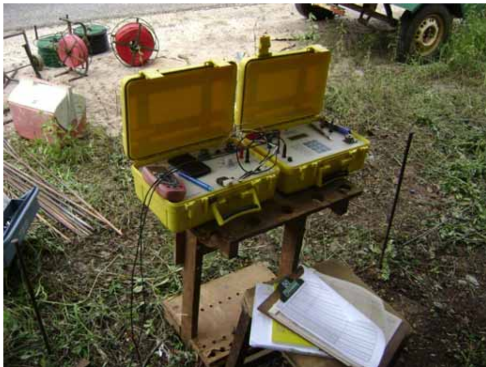
Foto 5.1 – Instrumentos utilizados na sondagem elétrica vertical: resistivímetro GEOTRADE (modelo GTR-3), fios, bobinas e eletrodos. (SEV 37: 657825, 9450063)
