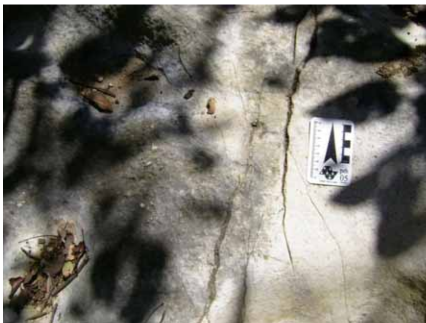
Foto 3.7 – Calcário Jandaíra com veios de calcita preenchendo fraturas de direção N-S (ANA-29; 656414, 9443643).
