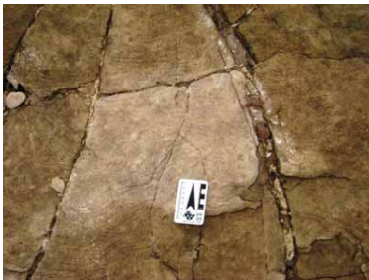
Foto 3.10 – Fraturas no arenito da Formação Açu, preenchidas por material carbonático, direção 38 Az (ANA-11; 611985,9436144).
