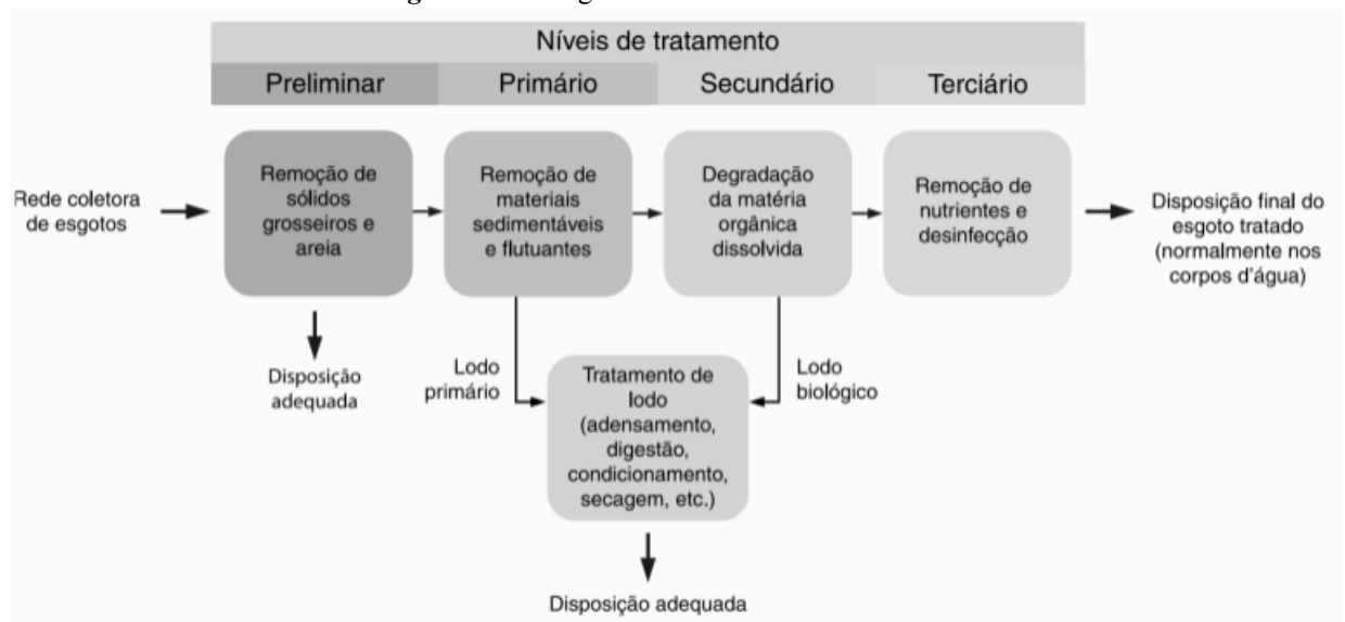
Figura 4 - Fluxograma do sistema de tratamento
