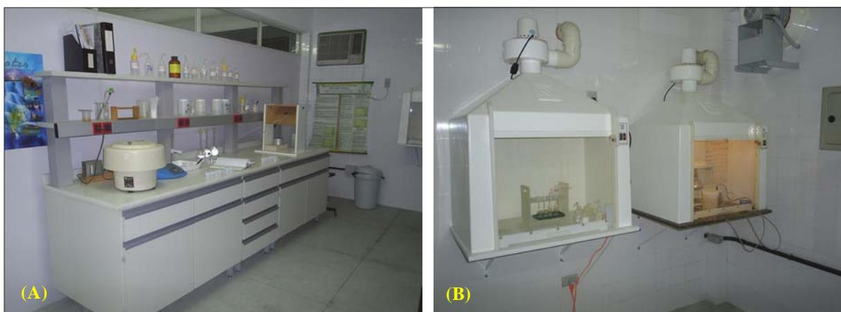
**Figura 1.3-** (A)- Bancada para preparação de amostras para análises isotópicas de Sr. (B)- Capela com colunas trocadoras de íons.
