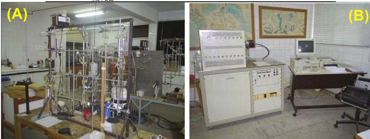
**Fotografia 1.1-** A- Linha de extração de CO<sub>2</sub> em operação no LABISE-UFPE e B - Espectrômetro de massa SIRA II para determinação de  $\delta^{13}\text{C}$  e  $\delta^{18}\text{O}$  em carbonatos.
