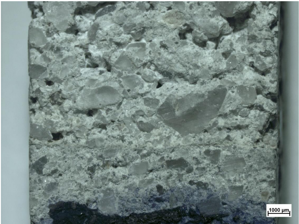
Zona de Transição Interfacial do agregado reciclado de concreto na condição (a) natural
