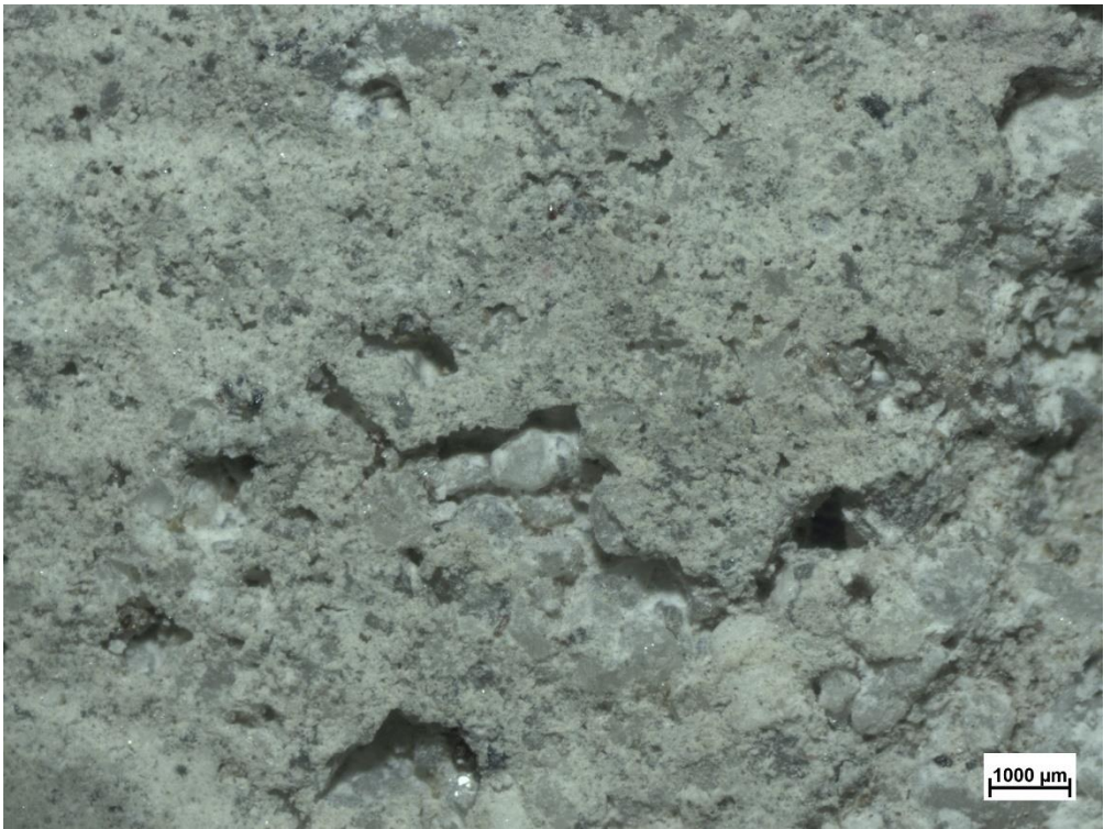
Imagens do estereoscópio das superfícies do agregado de concreto reciclado com a) superfície natural
