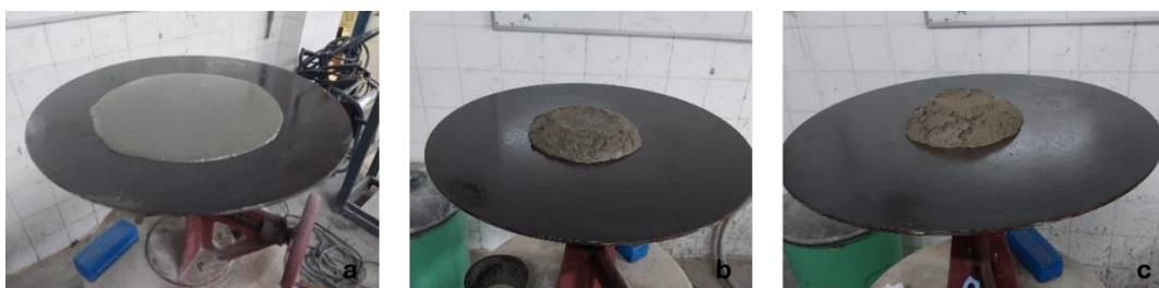
Figura 21. Teste na mesa para o teste de consistência nas amostras de argamassa a) REF, b) RP-V e c) RP.
