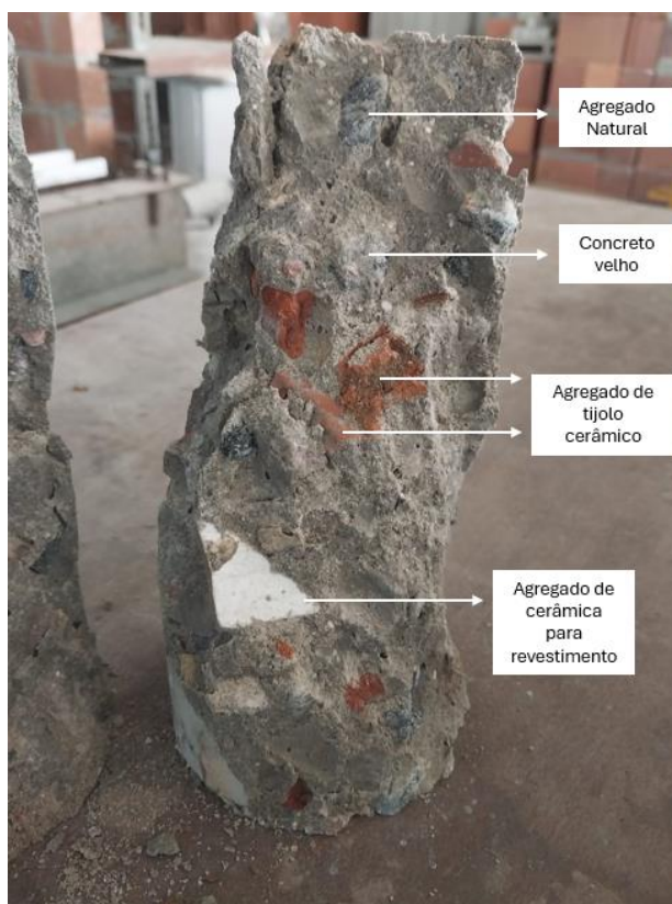
Figura 19. Corpo de prova após o rompimento e identificação dos principais elementos que compõem o agregado reciclado utilizado na composição.
