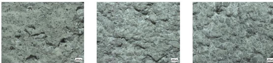
Figura 7. Imagens do estereoscópio das superfícies do agregado de concreto reciclado com a) superfície natural; b) superfície pós-tratamento mecânico e c) rugosidade pós lixamento simples.
