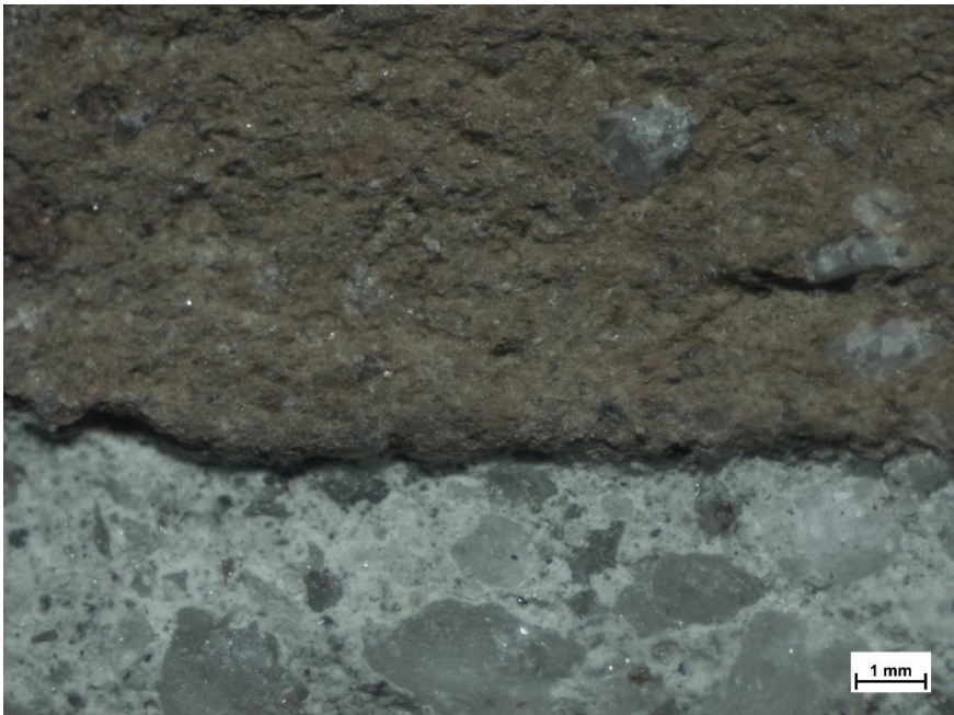
Zona de Transição Interfacial do agregado reciclado de tijolo cerâmico na condição b) com tratamento mecânico
