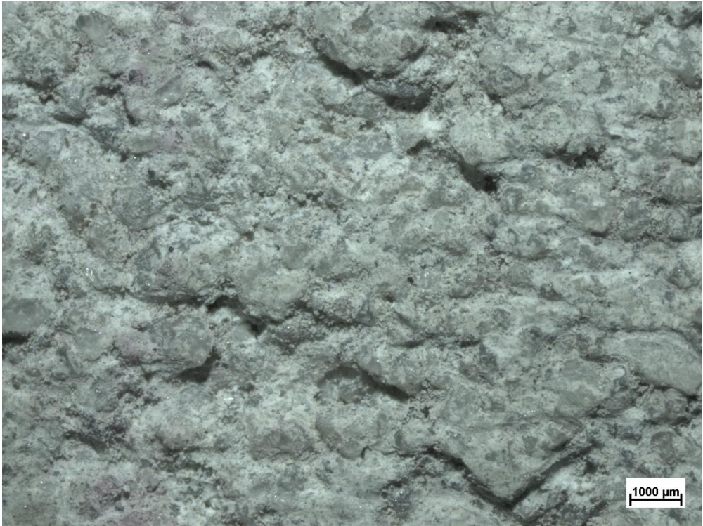
Imagens do estereoscópio das superfícies do agregado de concreto reciclado com b) superfície pós-tratamento mecânico
