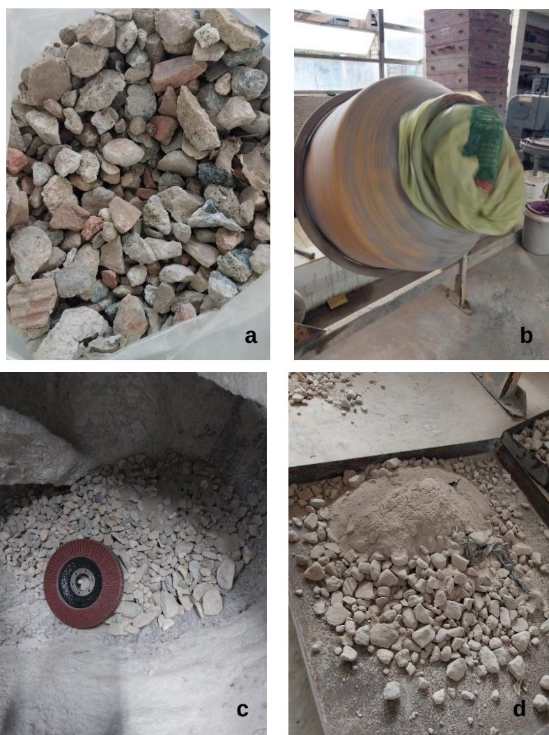
Figura 5. Tratamento mecânico do RCD: a) resíduo sem tratamento; b) betoneira em operação; c) disco abrasivo; d) resíduo tratado.
