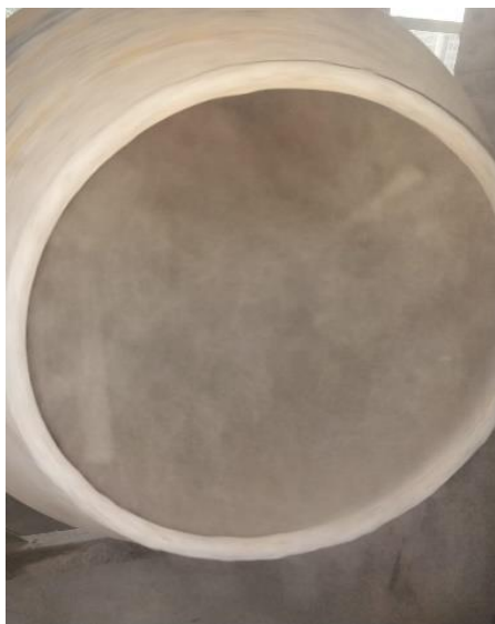
Figura 23. Aspecto do pó disperso no ar durante o tratamento mecânico.
