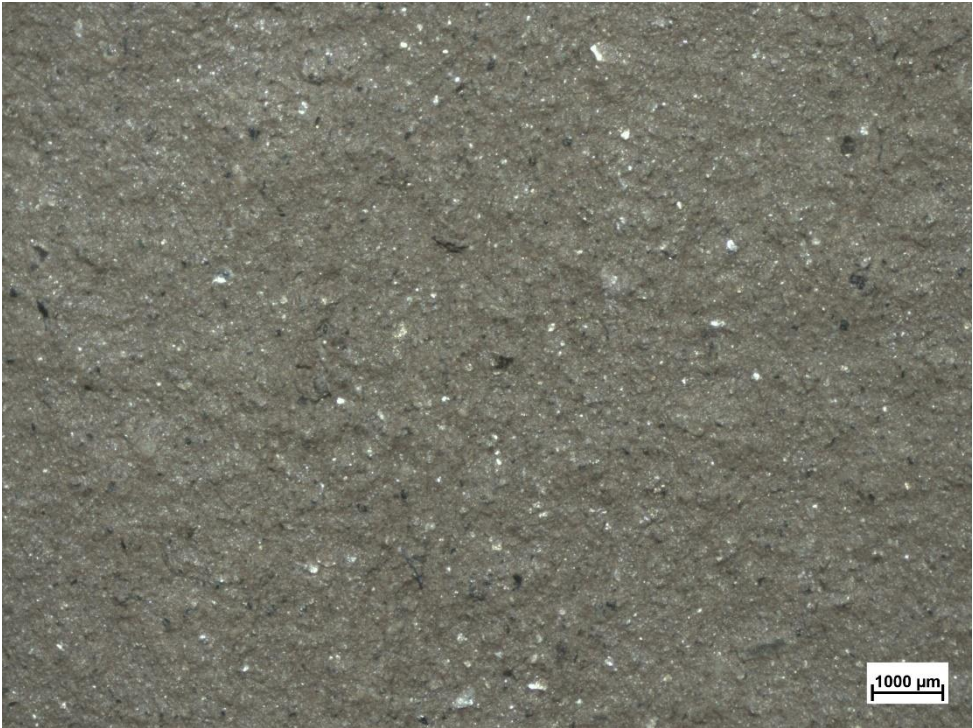
Imagens do estereoscópio das superfícies do agregado de tijolo reciclado com c) superfície pós lixamento simples
