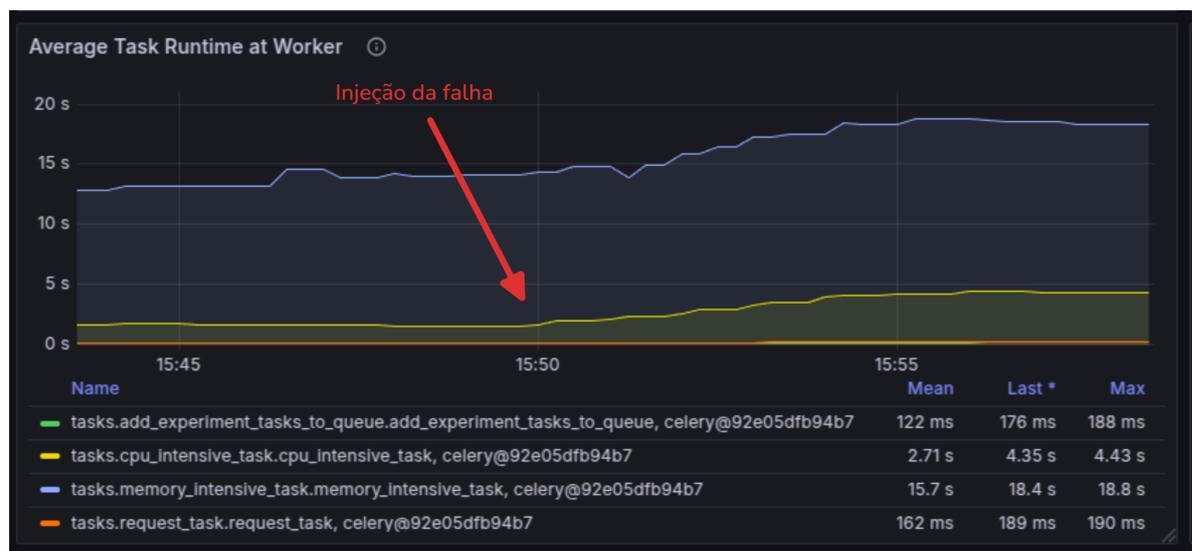
Figura 16 – Experimento com Exaustão de CPU - Gráfico do tempo médio de execução das tarefas
