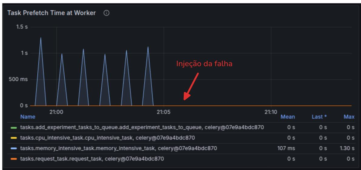
Figura 22 – Experimento com Exaustão de Memória - Gráfico do tempo de pré-carregamento das tarefas
