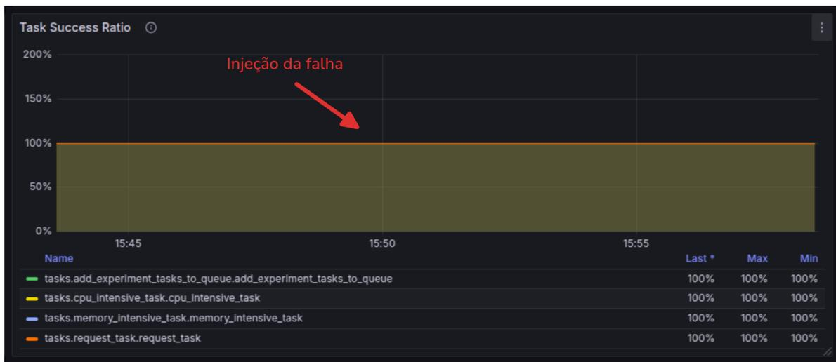
Figura 13 – Experimento com Exaustão de CPU - Gráfico da taxa de sucesso das tarefas
