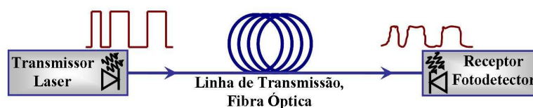
Figura 1.3: Sistema de comunicação óptica ponto a ponto.
