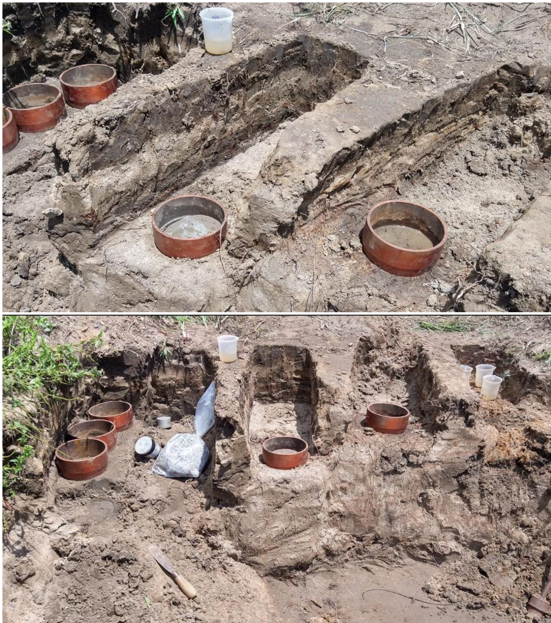
Figura 10 - Ensaio de infiltração na parede da trincheira.
