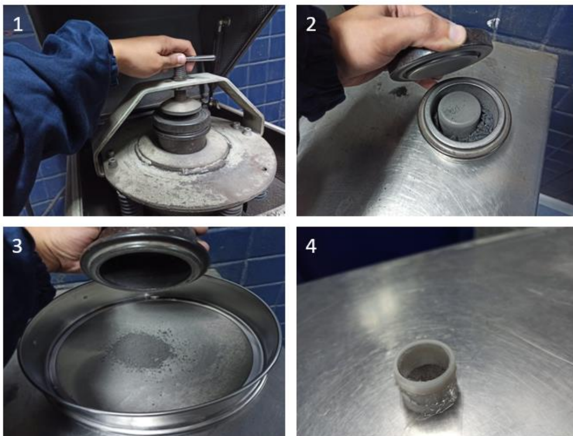
Figura 23 – Preparação de amostra de escória para análise em EDXRF
