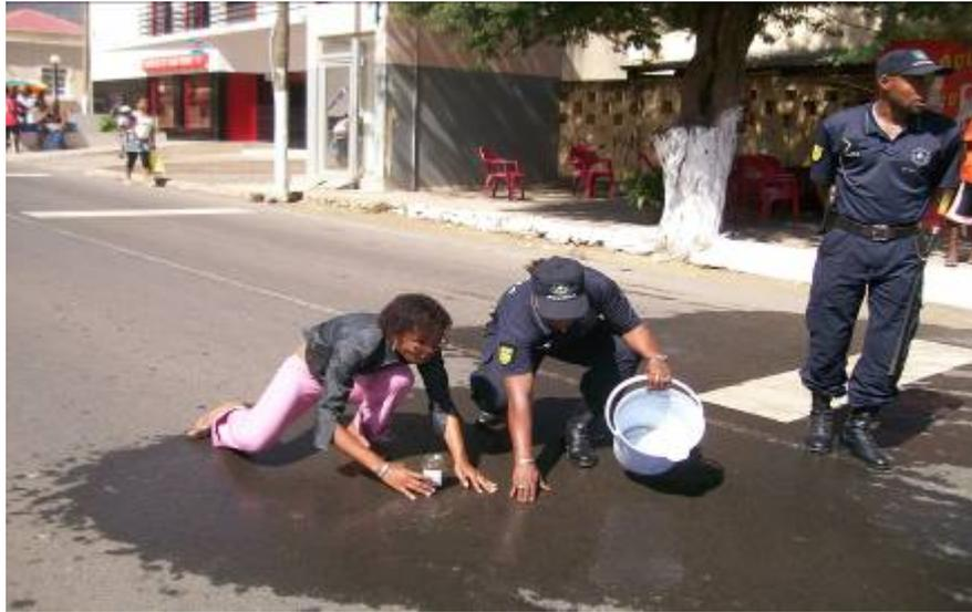
**Figura 15.** Lavagem do asfalto para coleta de água para análise. **Fonte:** Autora, 2009.
