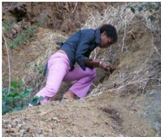
**Figura 12.** Implantação de estaca de monitoramento de erosão na zona dos picos. **Fonte:** Autora, 2008
